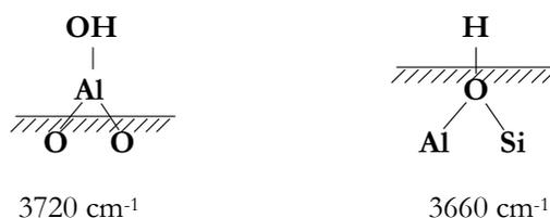
**Figura 4. 7.** Grupos hidroxilo en la zeolita HZSM-5 (Rodionov y cols., 2013).
