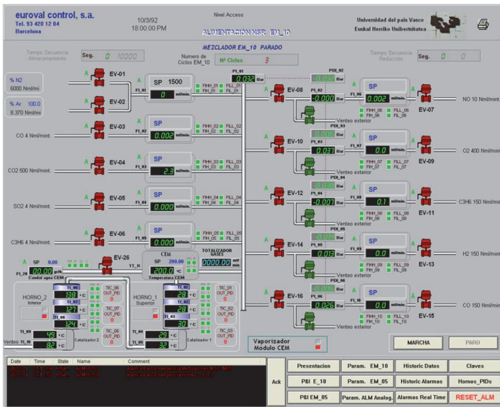
Figura 2.6. Interfaz gráfica del sistema de control (SCADA) de la bancada de reacción, gestionado a través de un controlador PLC Siemens.
