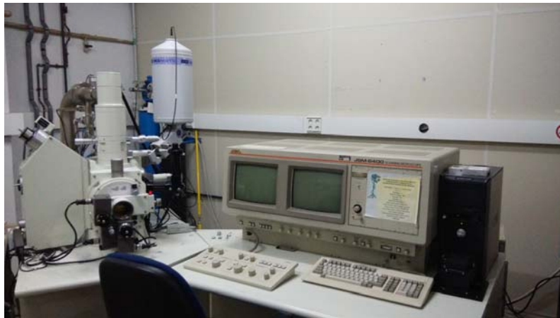
Figura 7.12. Microscopio Electrónico de Barrido (MEB), JEOL JSM-6400.
