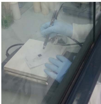
Figura 7.2. Imagen tomada durante el proceso de spray coating.
