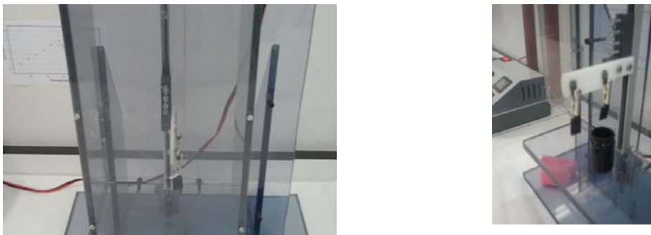
Figura 7.1. Imágenes tomadas durante el proceso de dip coating.
