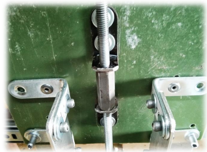
Figura 18. Detalle de la tuerca horizontal del eje Z.
