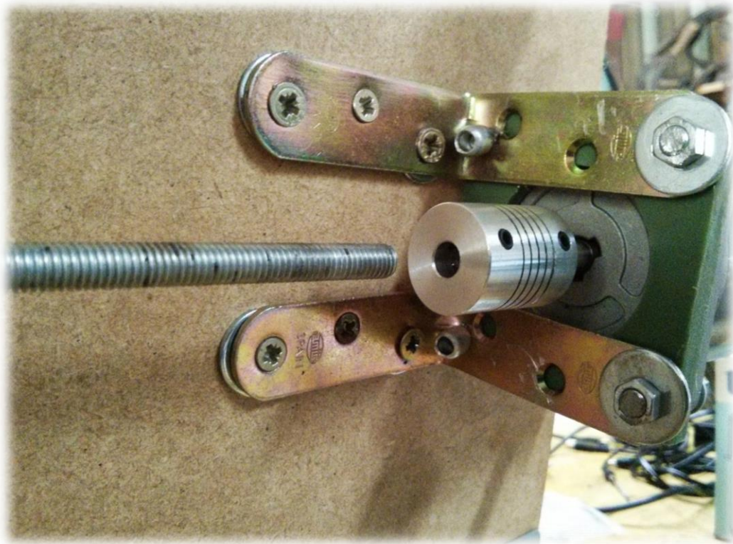
Figura 34. Detalle de la unión varilla-eje sin acoplar.
