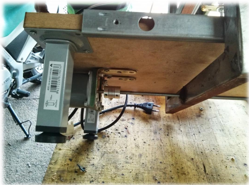
Figura 35. Detalle de la unión varilla-eje acoplado.
