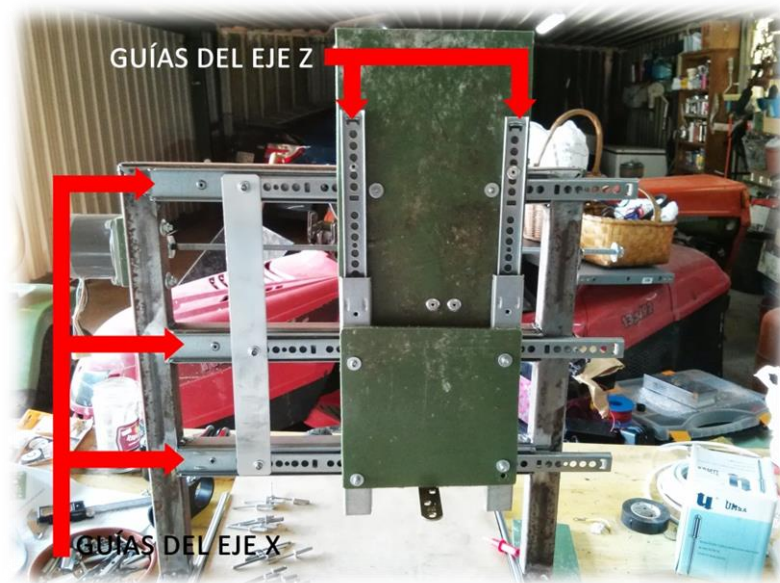
Figura 19. Detalle de las uniones de los ejes X y Z.
