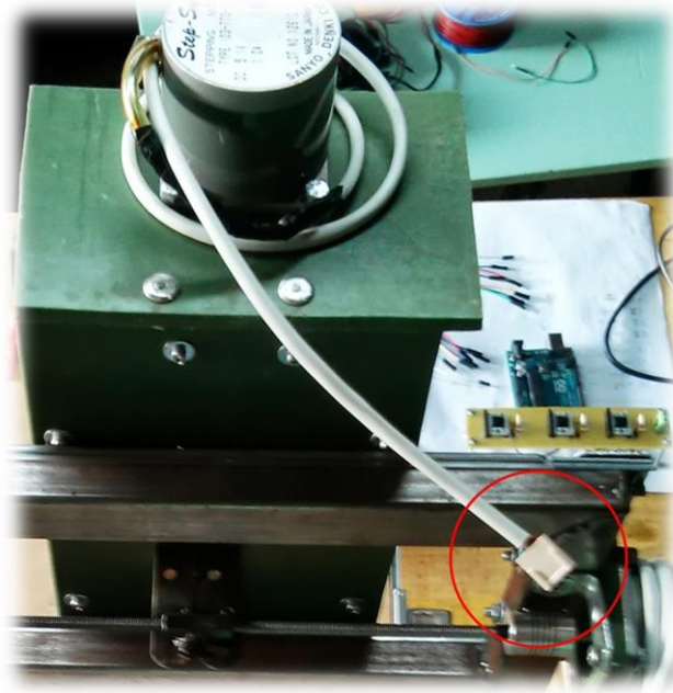
Figura 21. Detalle de la conexión rápida de los motores.
