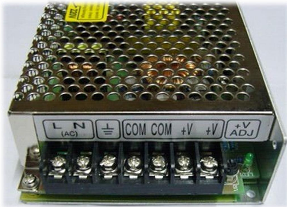
Figura 12. Detalle de las conexiones de la fuente de alimentación.
