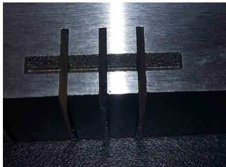
Fig. 78. Imagen representativa de la pieza tras el rebanado de la cavidad
