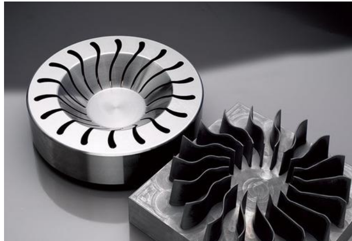
Fig. 35 Electrodo de grafito y la cavidad generada mediante su uso
