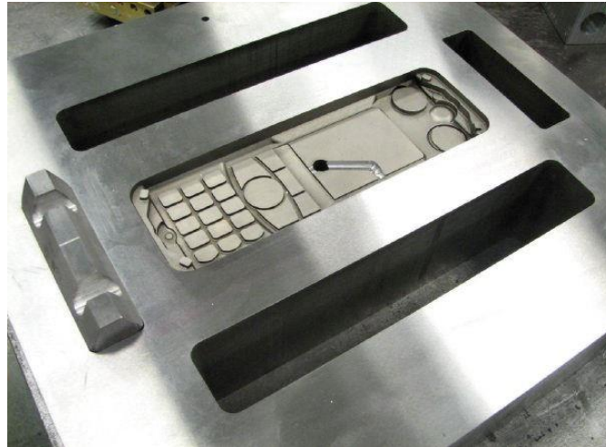
Fig. 34 Fig. Molde de inyección de plástico fabricado por SEDM.
