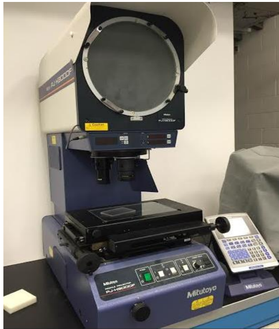
Fig. 22 Proyector de perfiles Mitutoyo PJ-H3000
