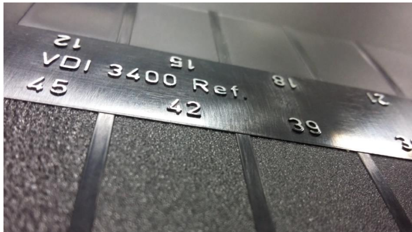
Fig. 52 Placa de referencias de rugosidades en función de distintos VDI
