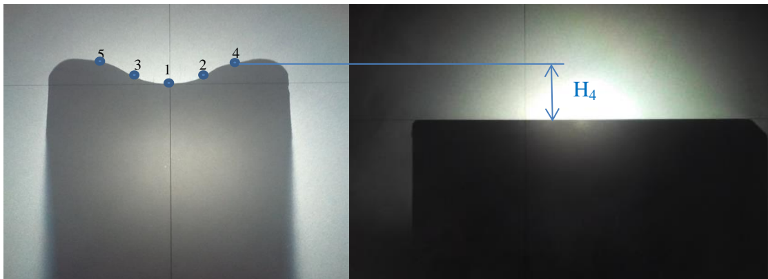
Fig. 101 Puntos a medir mediante el proyector de perfiles MITUTOYO PJ-H3000, ejemplo pto. 4
