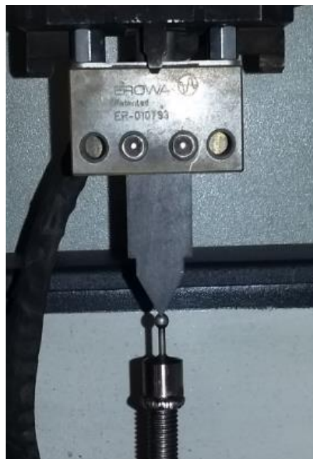
Fig. 69. Mediciones en máquina empleando la esfera de referencia
