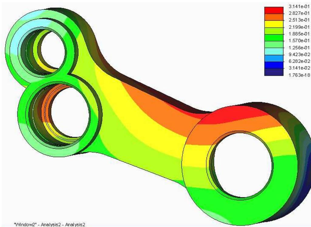
Figura 5.2.4. Análisis de las deformaciones del modelo II del balancín.
