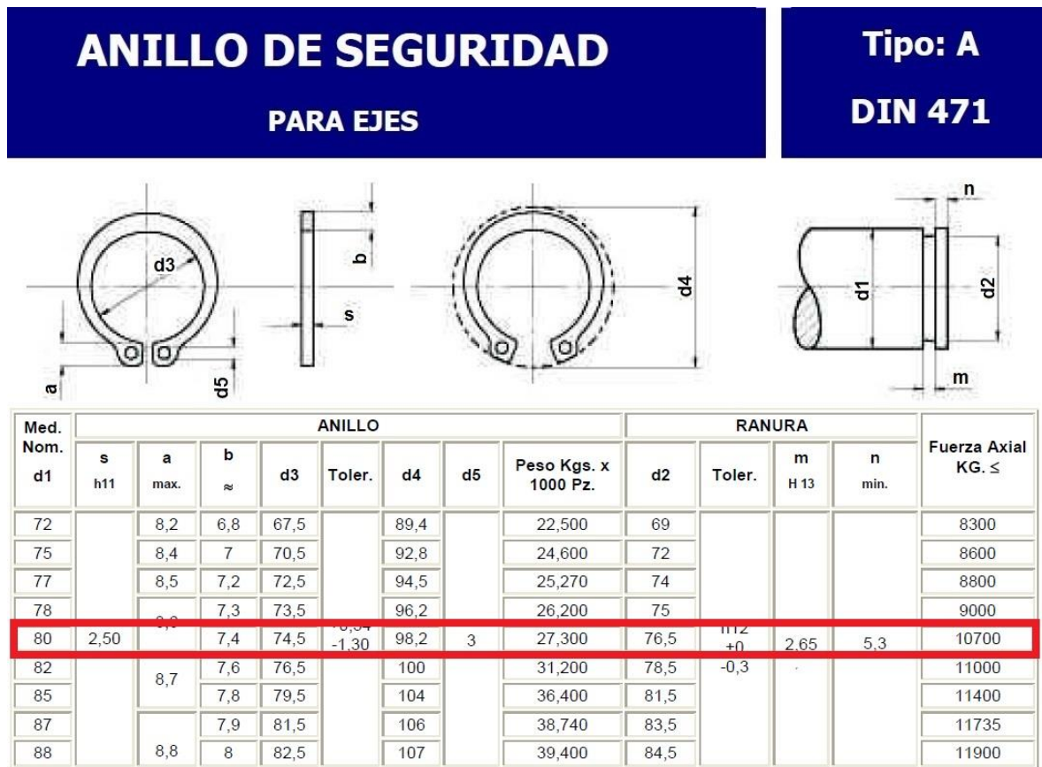
Figura 165. Características geométricas del anillo de seguridad
