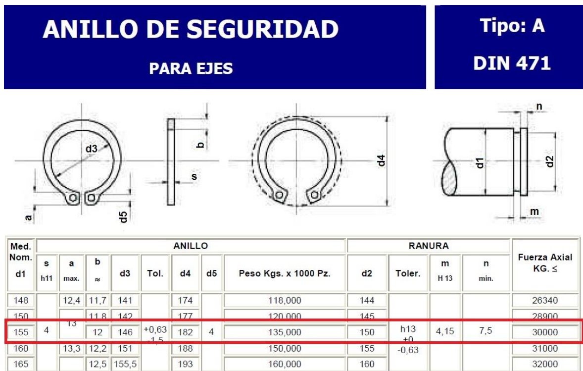
Figura 116. Características geométricas del anillo de seguridad
