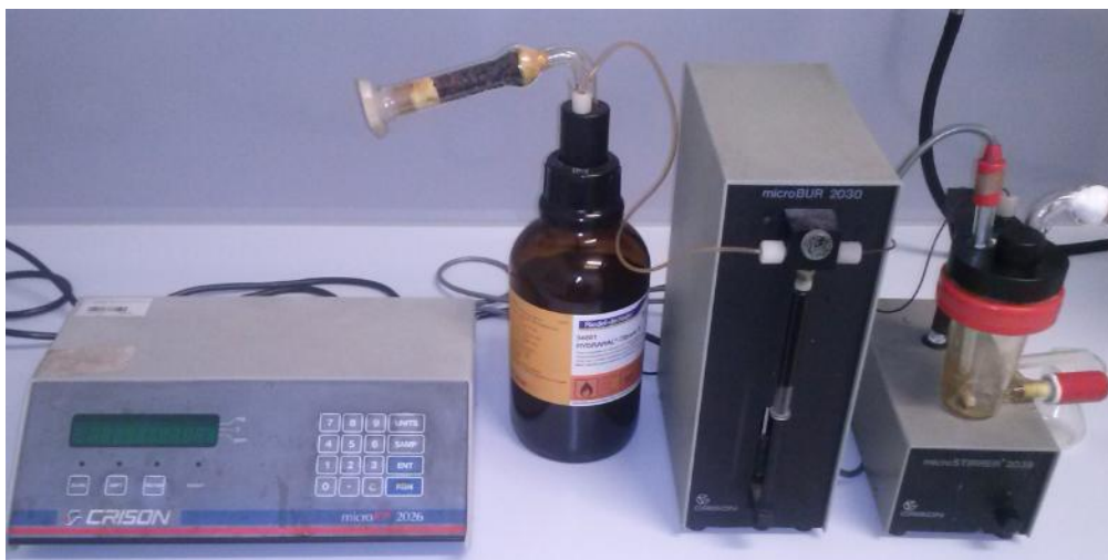
Figura 7.9: Determinación de agua según la norma ASTM D1744-83 con equipo Crison microKF 2026.
