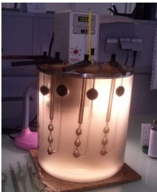
Figura 7.5: Medida de la viscosidad cinemática a 100 °C.
