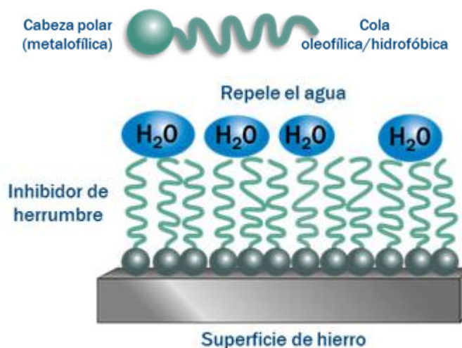
Figura 4.5: Acción de inhibidor de herrumbre.
