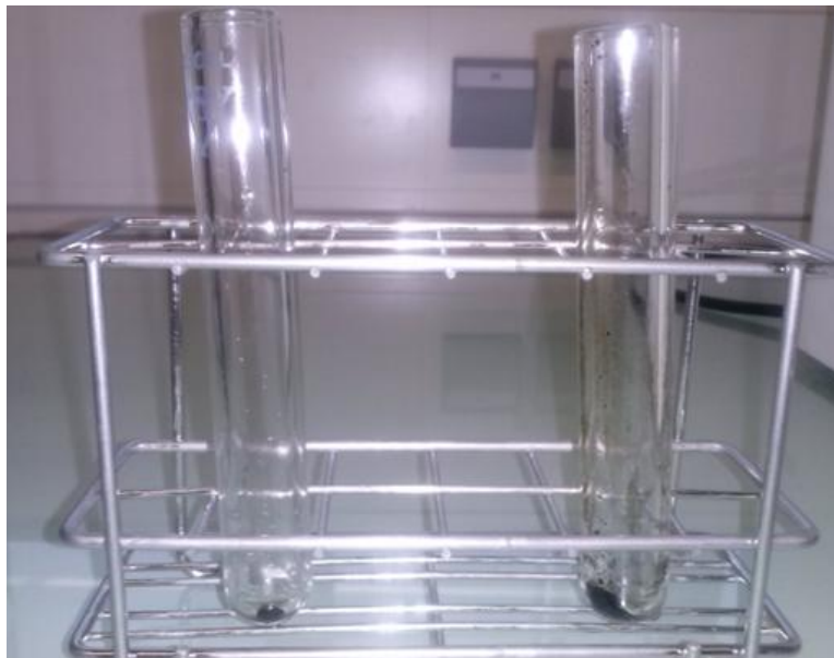
Figura 8.15: Residuo obtenido tras la eliminación del líquido sobrenadante después de la tercera extracción.
