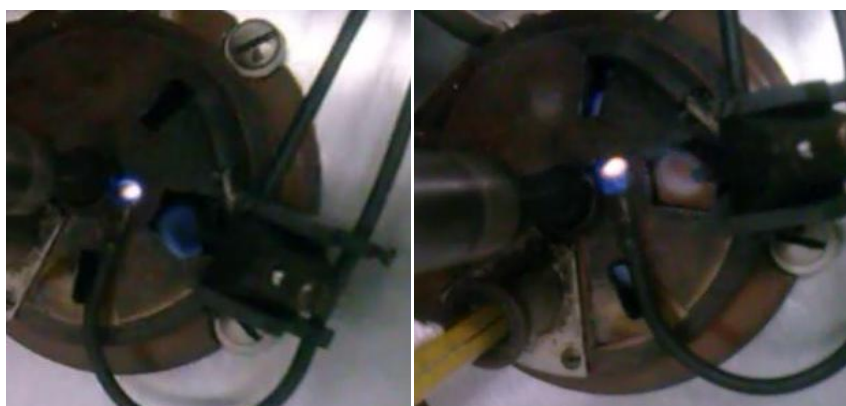
Figura 7.6: Imagen comparativa de la llama (izquierda) y de la inflamación (derecha).
