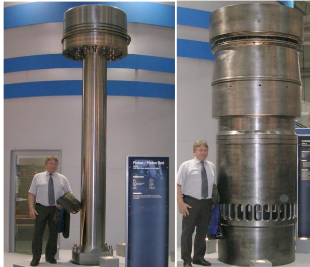
Figura 6.1: Componentes de un motor de cruceta; a la izquierda pistón y vástago, a la derecha camisa del cilindro.
