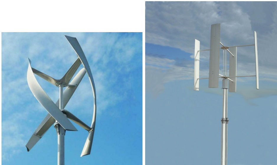
Irudia 1.20.: Giromill turbina mota desberdinak.
