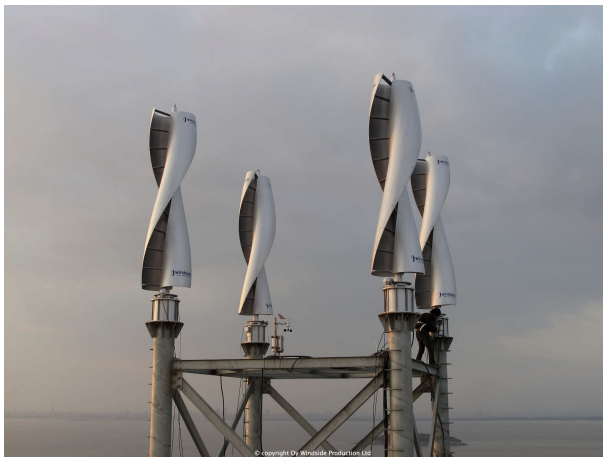
Irudia 1.18.: Savonius klasikoaren hobekuntza diseinuak.
