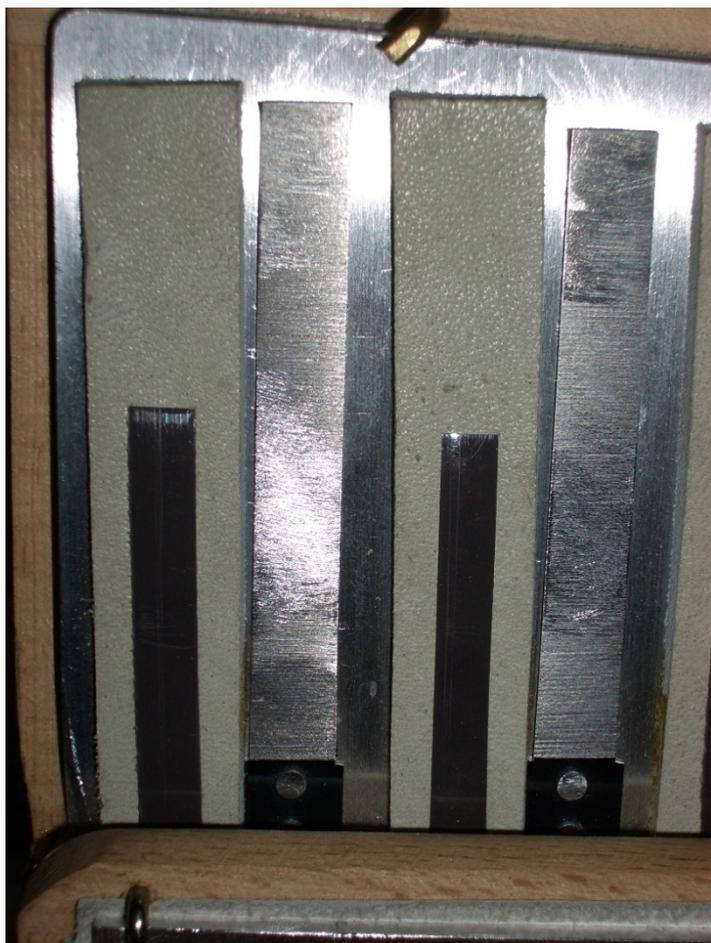
*Figura 1.14: Lengüetas de un acordeón ruso de la marca "Jupiter". Todas las lengüetas se remachan directamente sobre una placa metálica común.*
