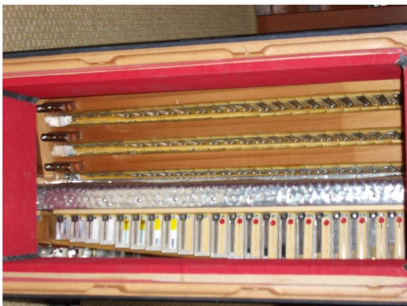
*Figura 1.4: Detalle de la cámara de resonancia o cassotto.*
