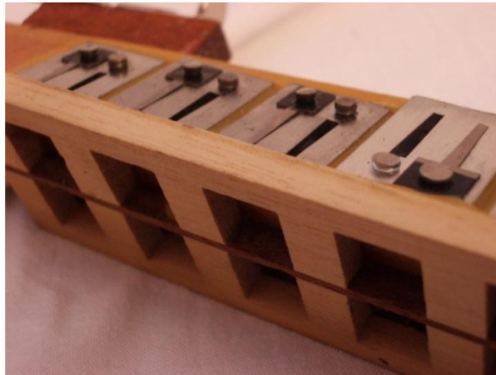
*Figura A1.5: Detalle de un bloque de lengüetas. Las lengüetas más pequeñas, asociadas a notas más agudas, se han dispuesto con la punta cerca del orificio de entrada a la cámara de resonancia.*
