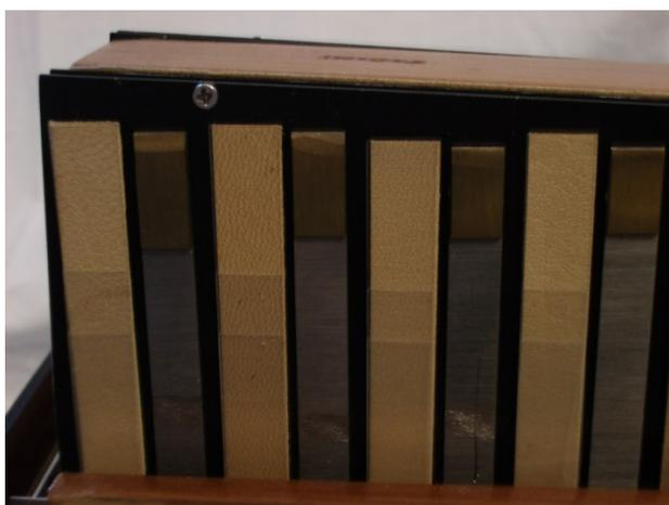
*Figura 1.12: Detalle de lengüetas graves remachadas directamente sobre una placa metálica común, a su vez colocada sobre un bloque de madera común.*
