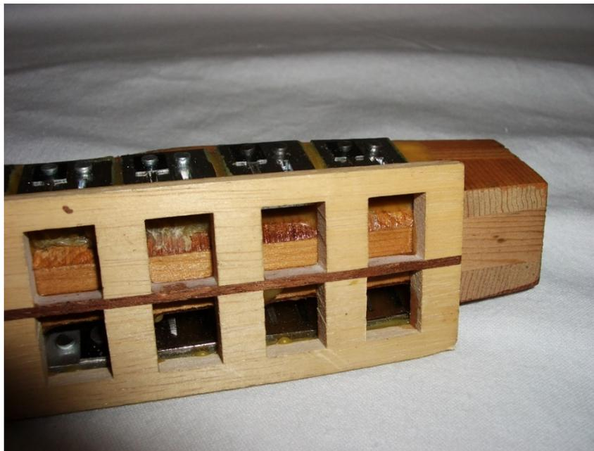
*Figura A1.6: Detalle de un bloque de lengüetas agudas. Las entradas a las cámaras de resonancia están modificadas para facilitar la entrada del aire.*
