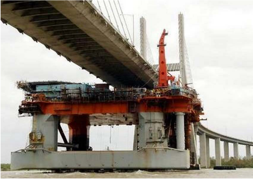
Figura 1.3 Plataforma petrolera que sufrió una rotura de las líneas de anclaje como consecuencia del huracán Katrina y se incrustó bajo el puente de Cochrane en Mobile, Alabama. El equipo estuvo a la deriva, libre de sus amarras, cuando la tormenta azotó la costa de Alabama y vino a estrellarse contra el puente. (fotografía Agencia France Press)
