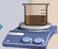
Se ha homogenizado la disolución en un agitador magnético y se ha añadido el combustible (glicina) en una relación  $G/N = 1$ .
