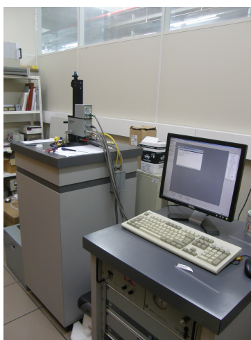
Irudia 3.4: ZFC-FC neurketak egiteko erabili den SQUID magnetometroa.
