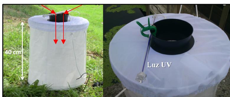
**Fig. 12.** Trampa BG-Sentinel. Se observa la lámpara de luz UV. Se representa con flechas la dirección de la corriente descendente de aire.
