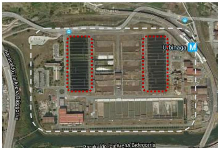
**Fig. 11.** Fotografía aérea tomada de (Google Maps©) donde se muestran las instalaciones de la E.D.A.R. de Galindo (limitadas por la línea blanca discontinua) y los clarificadores de Decantación Secundaria, este y oeste (líneas rojas de puntos).
