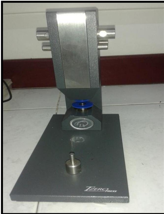
**Figura 3.2.** Prensa utilizada para el cierre de las cápsulas.
