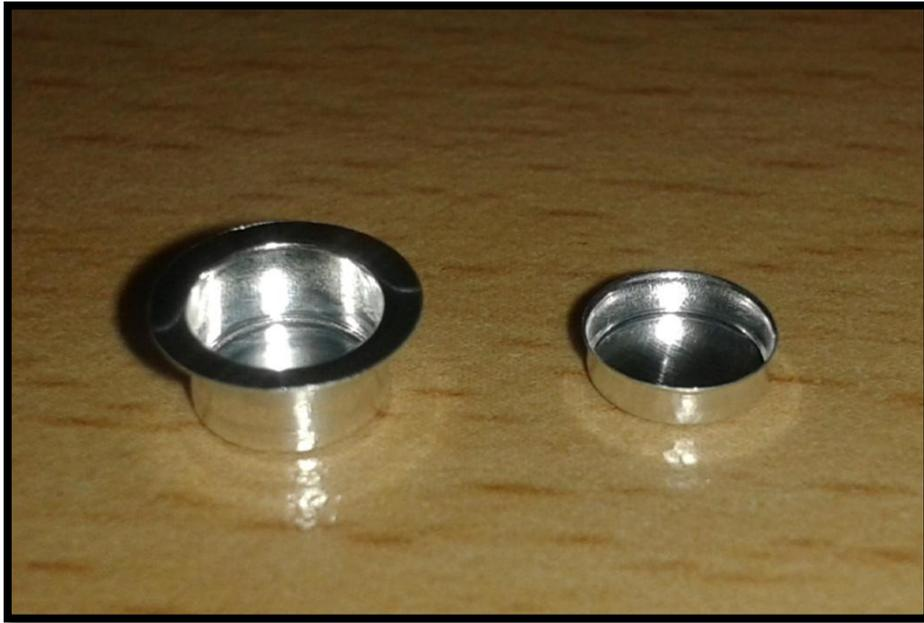
**Figura 3.1.** Cápsulas utilizadas en el DSC.
