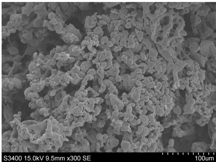
**Figura 6.9.** Micrografía SEM de scaffold realizado con PCL, templado a  $-60^{\circ}\text{C}$ , y con una proporción (v/v) de 1,4 dioxano y agua 99:1.
