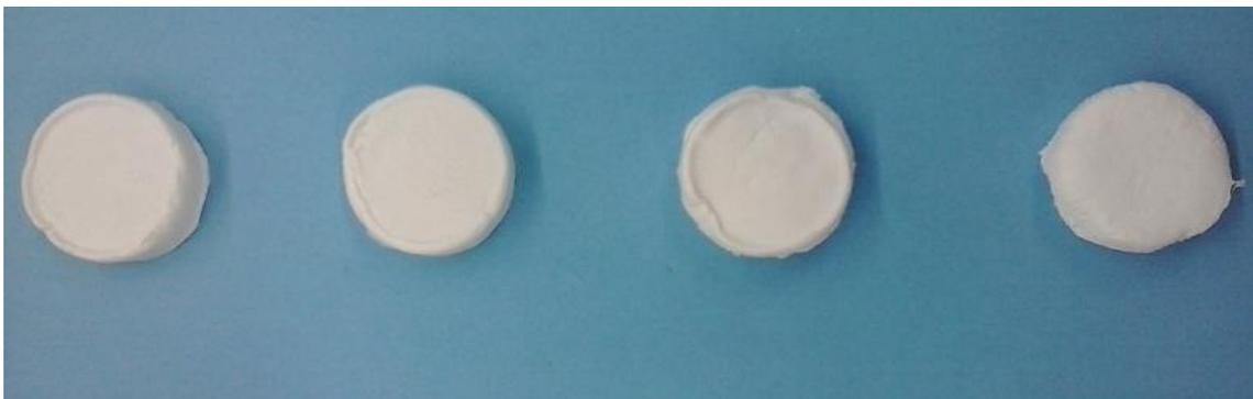
**Figura 5.5.** Scaffolds resultantes tras el proceso de liofilización.
