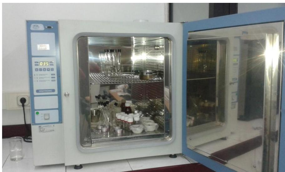
**Figura 5.6.** Degradación *in vitro* en la estufa a 37°C.
