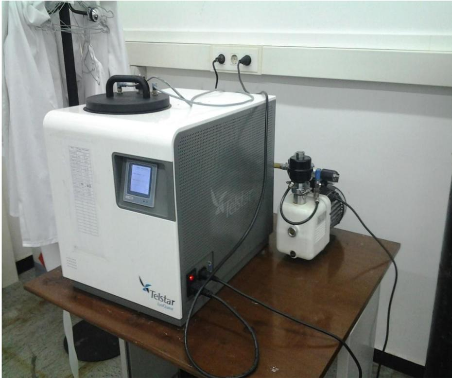
**Figura 5.4.** Liofilizador Telstar lyoquest -85.
