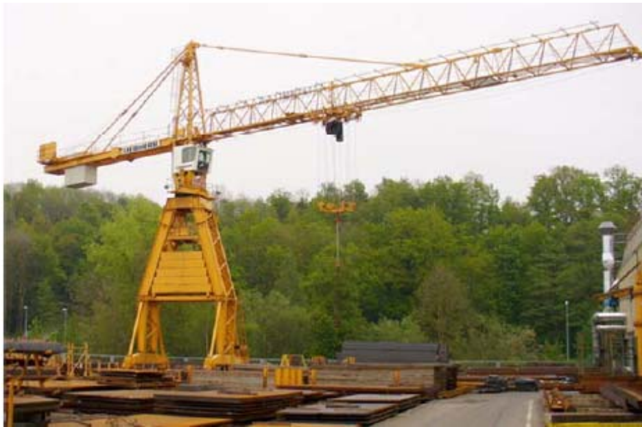
Figura 17. Grúa torre desplazable en servicio
