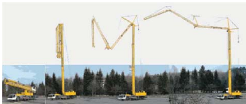
Figura 20. Grúa torre autodespegable
