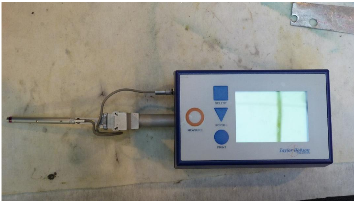
Figura 2.37. Rugosímetro Taylor-Hobson Surtronic 25.
