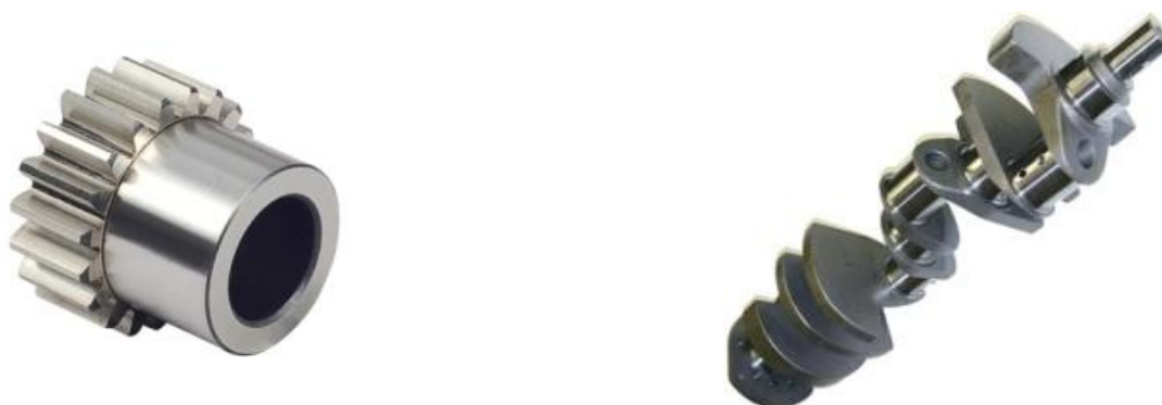
Figura 4.5. Piezas mecanizadas mediante procesos de rectificado
