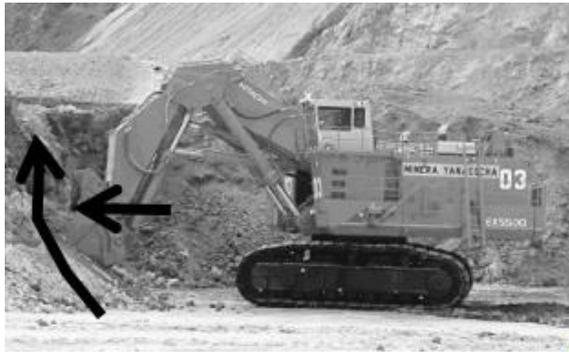
*Figura 3.9. Excavadora de empuje frontal.*
