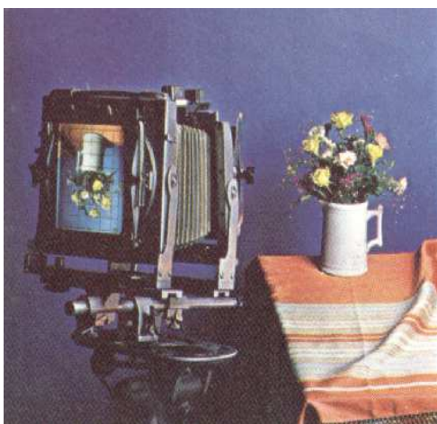
Fig. 98. Sobre la placa de una cámara fotográfica aparece invertida la imagen del objeto enfocado.
