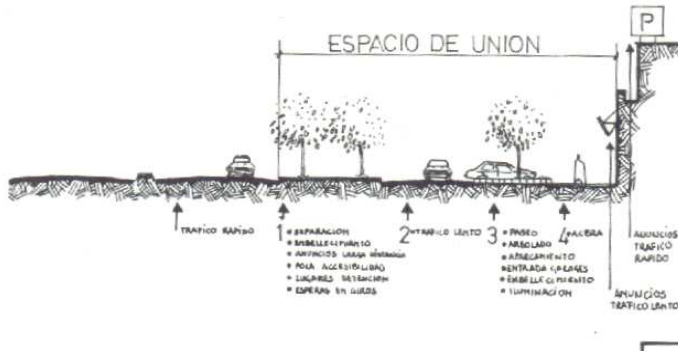
Fig. 321. Sección de vía principal con franjas arboladas.
