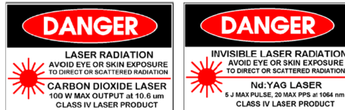
Figura 8. Señalizaciones de peligro de los láseres de Clase 4
