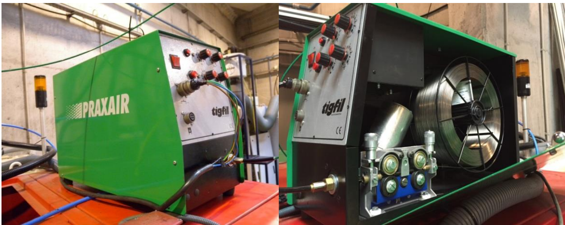
Figura 12. Alimentador de hilo Tig-Fil y bobina de hilo dentro del alimentador
