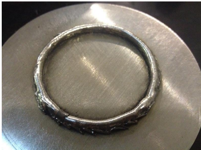
Figura 28. 6 capas de aporte de un círculo de diámetro 45 mm
