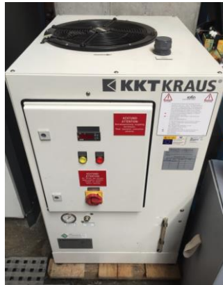
Figura 11. Sistema de refrigeración de láser KKT Kraus
