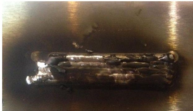
Figura 25. Cascarilla formada sobre los cordones
