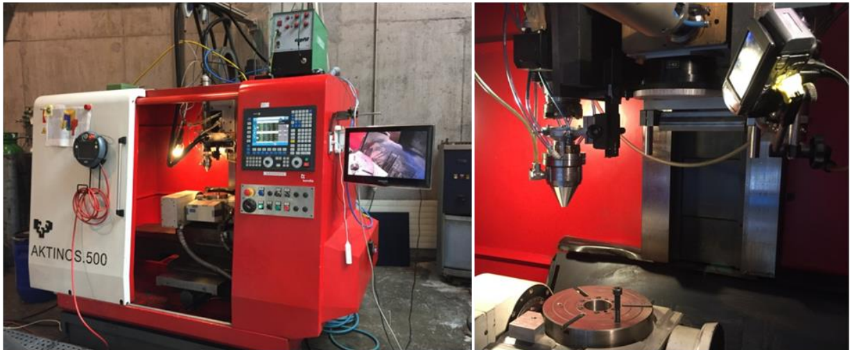
Figura 10. Máquina para procesamiento láser Kondia Aktinos-500
