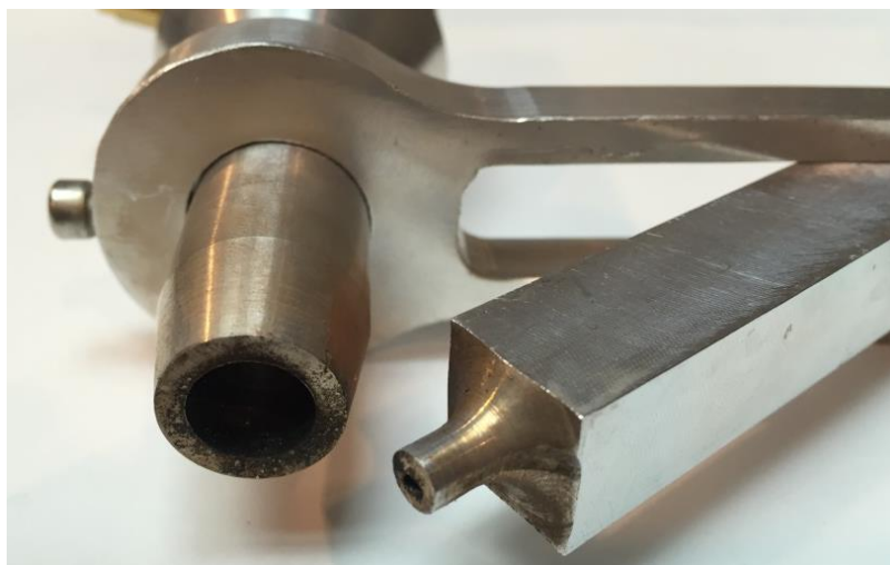
Figura 52. Sistema de alimentación afectado por el calor
