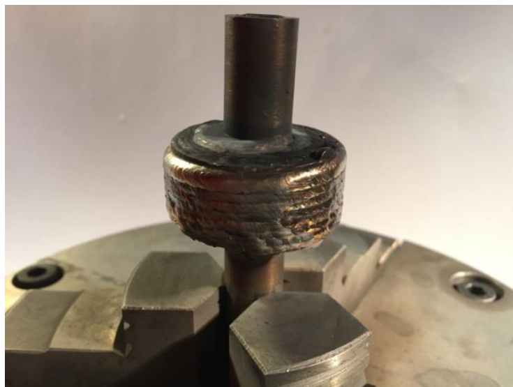
Figura 46. Pieza test con 20 capas y 7 cordones y medio por capa
