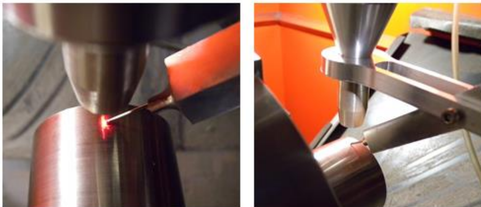
Figura 30. Sistema de alimentación con un correcto posicionamiento del hilo
