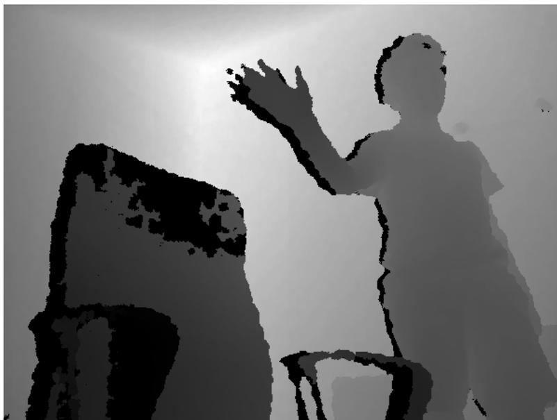
Figura 3.1: Ejemplo de imagen de profundidad obtenida con Kinect
