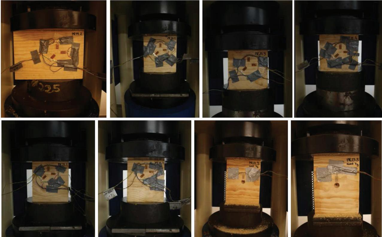
Resultados de las deformaciones de relajación captadas por las tres galgas tras la operación de Hole Drilling en las probetas de comprobación con la carga perpendicular a la dirección de las fibras
