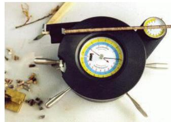
Figura 5.27 Fractómetro (Fuente: IML)
