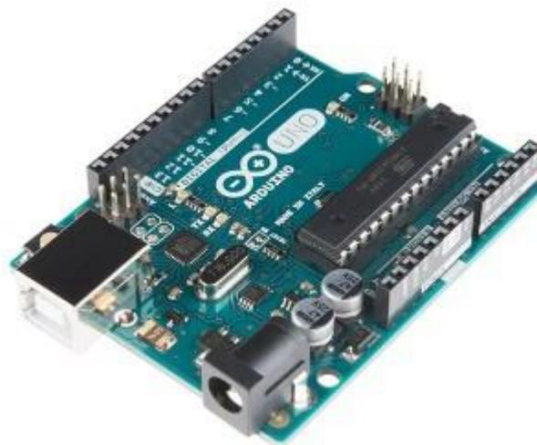
Figura 1 Placa Arduino Uno r3 [A-F-2016]
