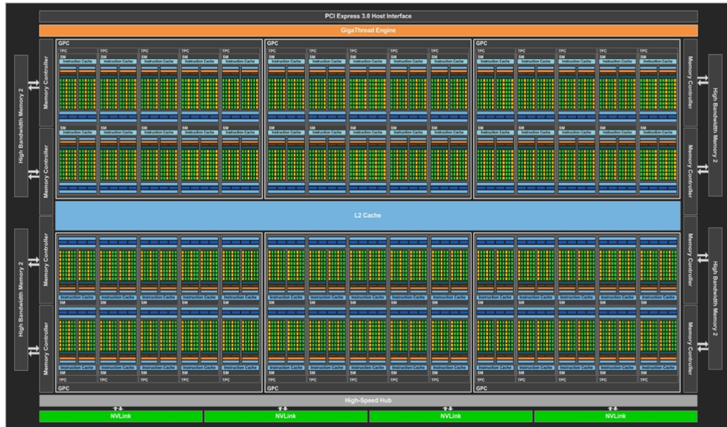
Figura 2.17: Arquitectura Pascal de la GPU GP100
