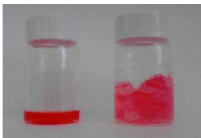
Figura 26. Aspecto típico de un copolímero Poli(OEGMA-co-AEMA) soluble (izquierda). En condiciones de síntesis no controladas, se obtuvieron geles insolubles (derecha).
