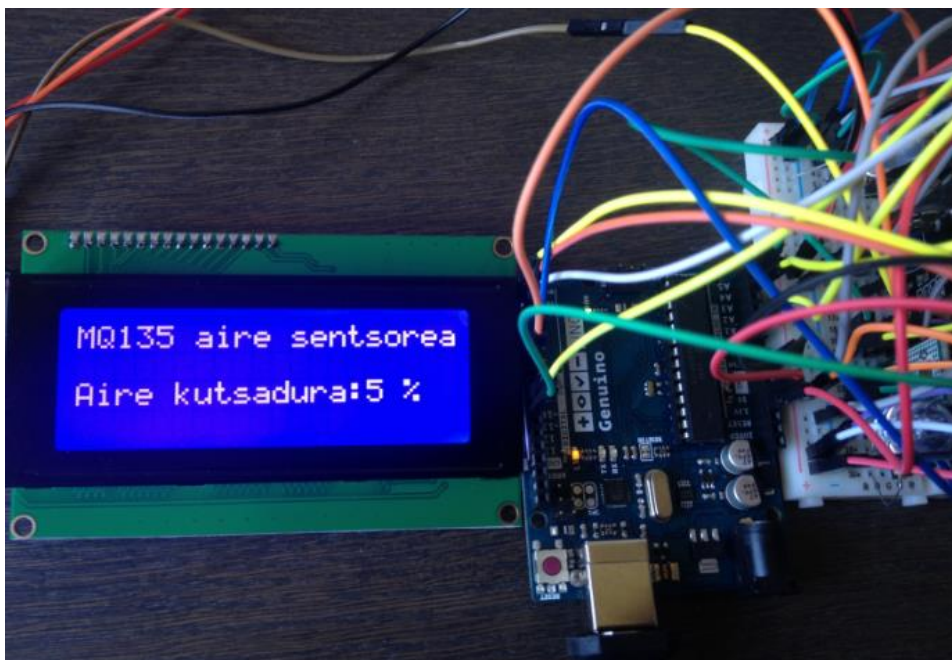
2.3.21.Irudia Sentsoeren neurketak LCD pantailan bistaratuta
