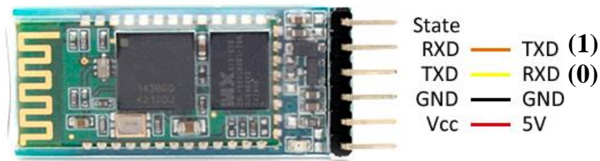
2.3.22. Irudia HC-05 bluetooth modulua Arduino plakarekin konektatzeko 4 konexio pin beharrezkoak izango dira. Lehenik eta behin bluetooth modulua elikatu beharko da 5V-ekin, horretarako, modulua Vcc pina Arduino plakaren 5V pinera konektatuko da eta modulua GND pina plakaren GND pinera. Ondoren, serie komunikazioa ahalbidetzeko, eta neurketa sentsoreak jasotako datuak smartphonerara bidali ahal izateko, modulua RXD pina, Arduino plakaren TXD pinera konektatu beharko, zein ataka digitaleko 1 pinean kokatuta dagoen. Bestetik, modulua TXD pina, plakaren RXD pinera konektatu beharko da, ataka digitaleko 0.pinean kokatuta dagoena. State konexio pina konektatu gabe utziko da, aplikazio honetarako eraginik ez duelako.
