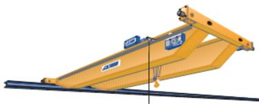
Las medidas A1, C1 y K1 se pueden cambiar para ajustarlas a las condiciones del edificio de cada caso concreto, simplemente elevando la parte inferior de la viga principal hasta la parte inferior del testero.
