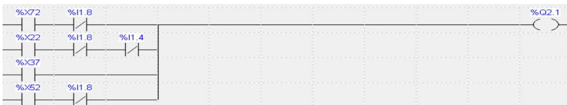
96. irudia. %Q2.1ren konfigurazioak hartzen duen itsura POST atalean. PL7 PRO.
