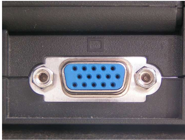
40. irudia. VGA kablea DB-15 konektoredunaren konexio emea.
