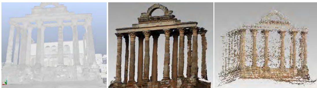
Figura 172. Comparativa de los resultados previos a edición (nube de puntos) de scanner láser, fotogrametría y videogrametría, por P. Ortiz en 2012. ORTIZ – DEL PINO 2013: 92-93.
