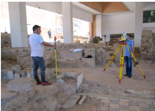
Figura 21. Georreferenciación de puntos con estación total.
