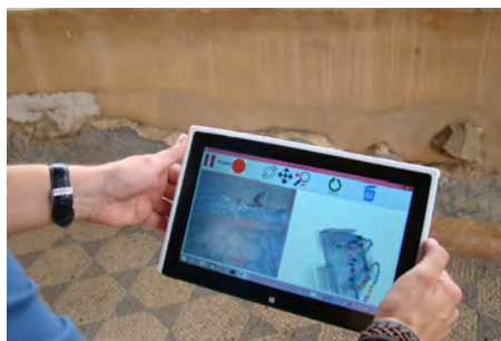
Figura 174. Detalle del uso de la tableta durante la captura de imágenes. A la izquierda se observa la imagen capturada y a la derecha el recorrido realizado.
