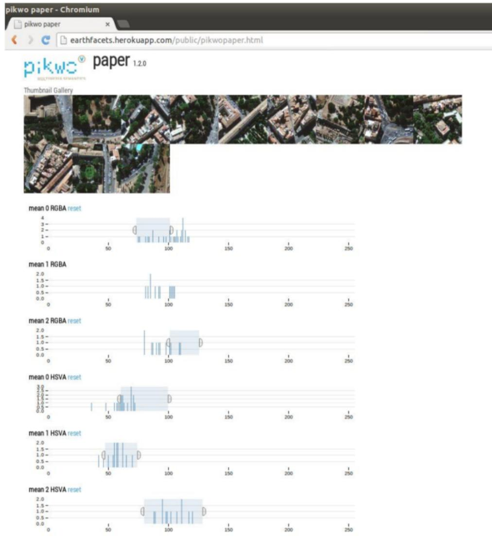
Figura A.5: Resultados de la búsqueda de árboles: Las áreas arboladas se identifican por zonas de baja luminosidad y con alta saturación, debido a las sombras visibles en ellos. La selección de un segmento específico en el matiz del color, parámetro H en el espacio de color HSV, hace que sea innecesario el uso de la componente verde para el filtrado en el espacio de color RGB.
