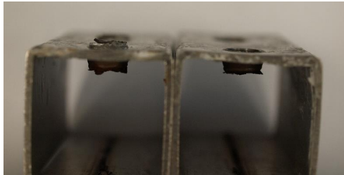
Figura 70. Comparativa de la rebaba producida en el proceso, para condiciones de diámetro óptimo (izquierda) y para mayor espesor de copa (derecha)
