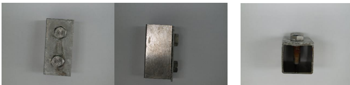
Figura 68. Probetas de acero inoxidable ensayadas (360 horas)
