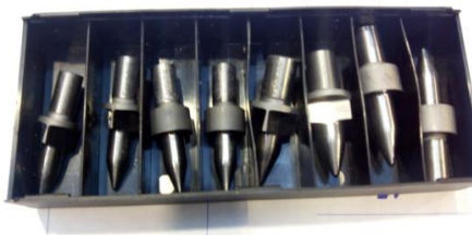
Figura 31. Puntas de taladrado por fricción (izquierda) y macho para roscado por laminación (derecha)
