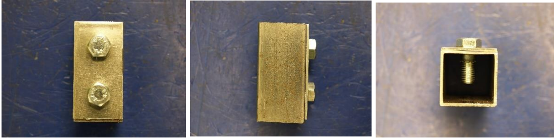
Figura 66. Probeta para ensayo de corrosión antes de ensayar
