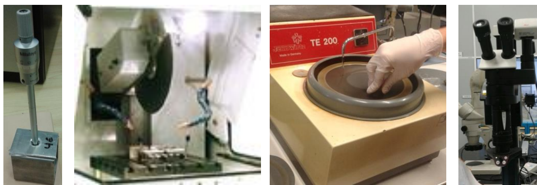
Figura 53. Proceso para la medición de las características geométricas de los agujeros
