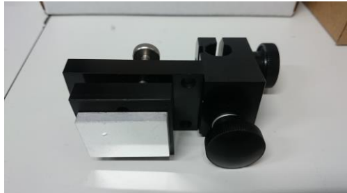
Ilustración 73: Espejo utilizado en las mediciones
