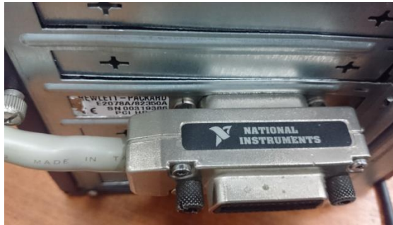
Ilustración 109: Detalle de la conexión GPIB
