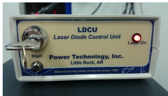
Ilustración 122: Alimentación del láser de Power Technology
