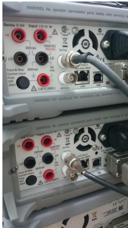
Ilustración 32: Conexión de la salida del generador con el trigger externo de los multímetros
