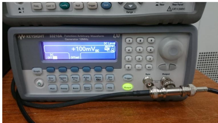
Ilustración 31: Detalle de la salida dividida en dos que está conectada al trigger externo de los multímetros
