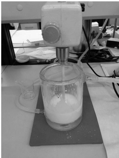
*Figura 10.- Montaje de preparación de SAPO-11. Etapa de homogenización de  $H_3PO_4$ , y pseudobohemita.*
