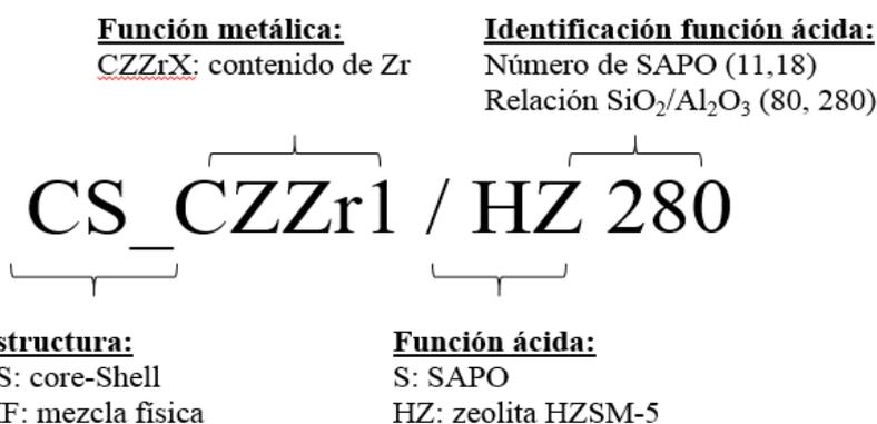
Figura 15.- Esquema de denominación del catalizador bifuncional.
