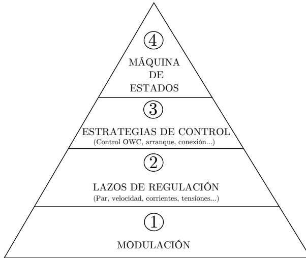
Figura 6.7: Estructura del control de un sistema OWC.
