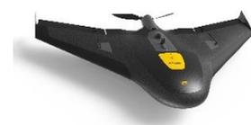
*Ilustración 5. Ejemplo de dron de ala fija Trimble UX5 HP. (<http://uas.trimble.com/>)*
