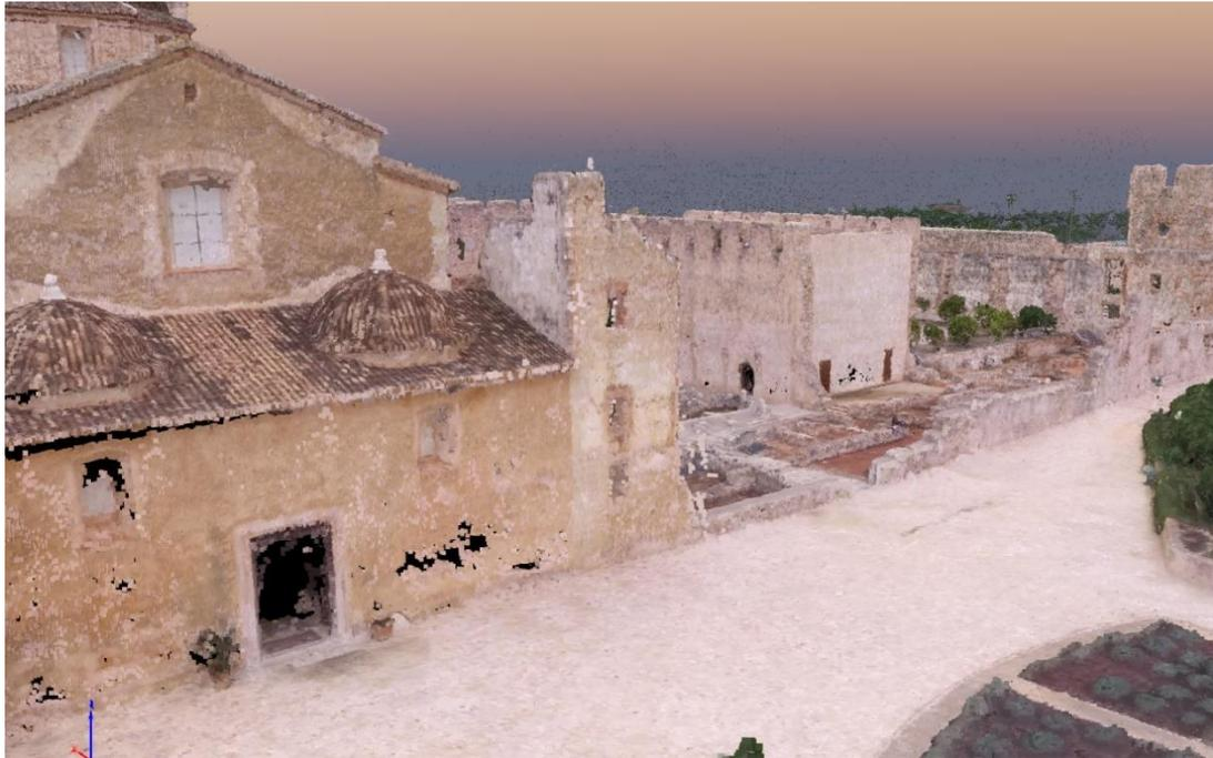
Ilustración 47. Ejemplo de zonas sin datos dentro de la nube densificada. (Captura de pantalla de PIX4D)
