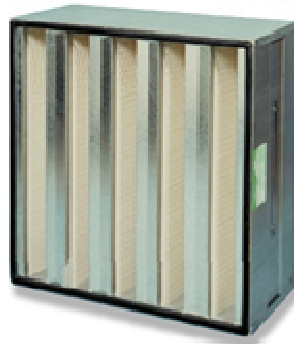
Figure 8: Filtro de alta eficiencia HEPA 14 (H-14) con estructura de acero galvanizado y junta continúa sellante en el marco. Papel de fibra de vidrio como medio filtrante, cordones termosellados como separadores y poliuretano como material sellante. Pérdida de carga recomendada de 600 pa. Temperatura máxima: 80°C.
