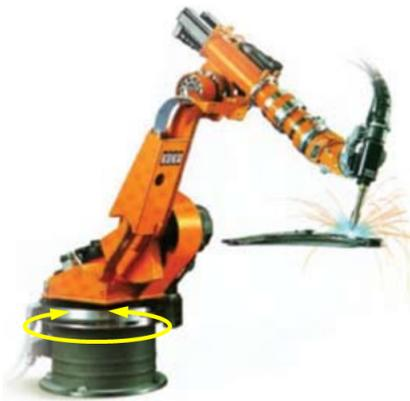
g) Rodamientos de vuelco en robots [Iraundi, 2011].
