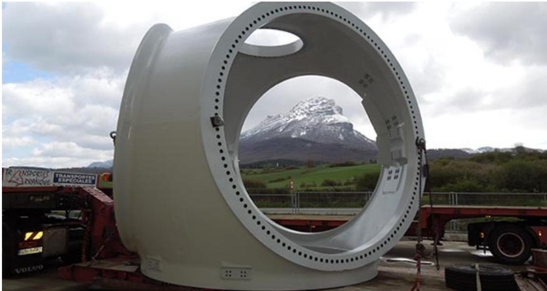
Figura 2.36: Buje de un aerogenerador (Fuente: <http://www.structuralia.com/>)
