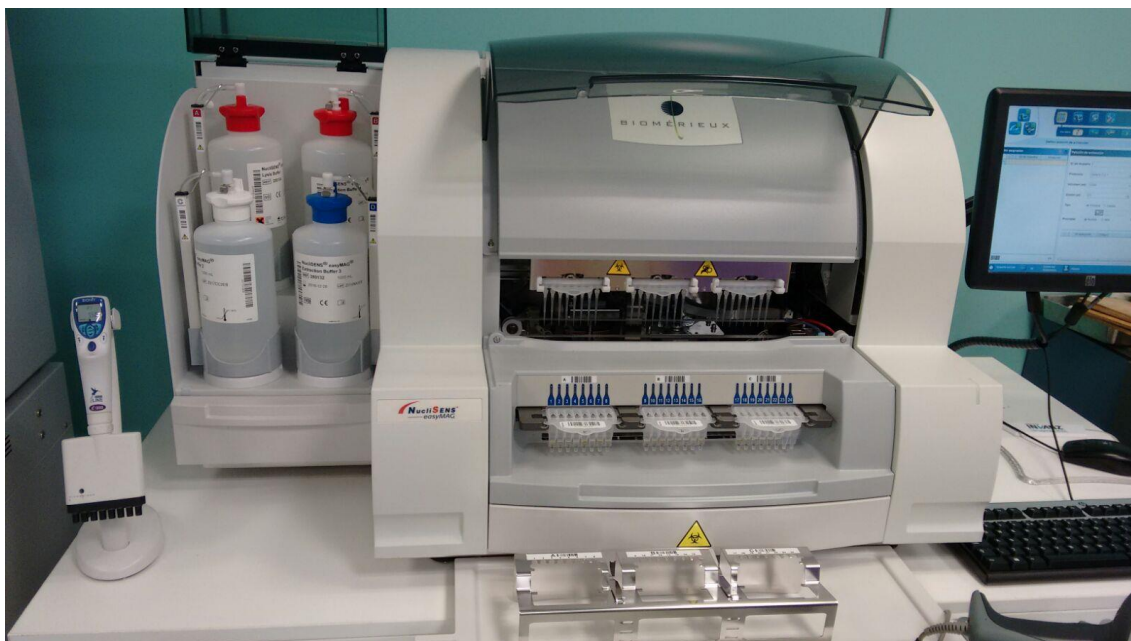
Figura 13.- Fotografía de la plataforma de extracción de ácidos nucleicos NucliSENS® EasyMAG®.
