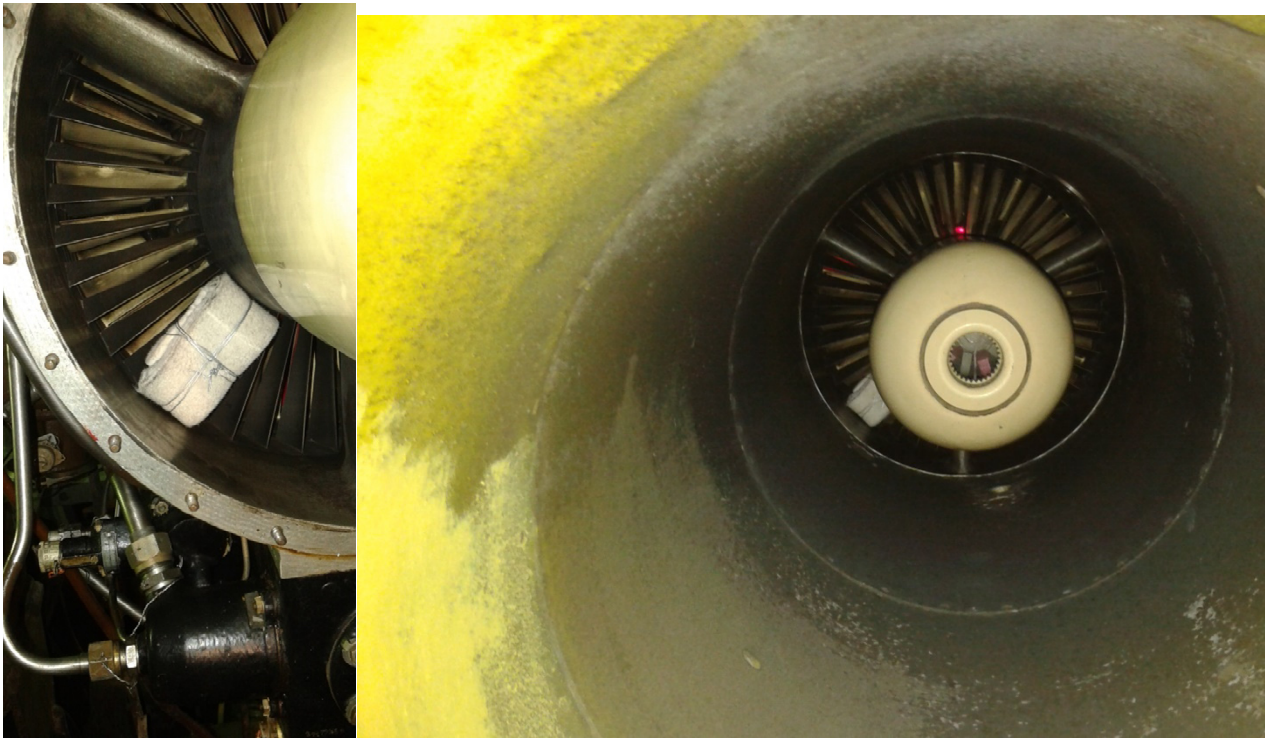
Figura 49. Blocker utilizado para simular un FOD antes (izquierda) y después (derecha) de montar la entrada de aire del motor.
