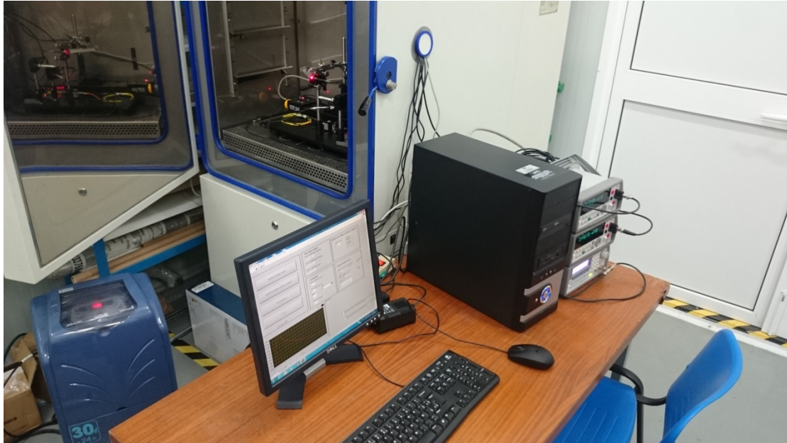
Figura 32. Calibración del sensor en la cámara climática.
