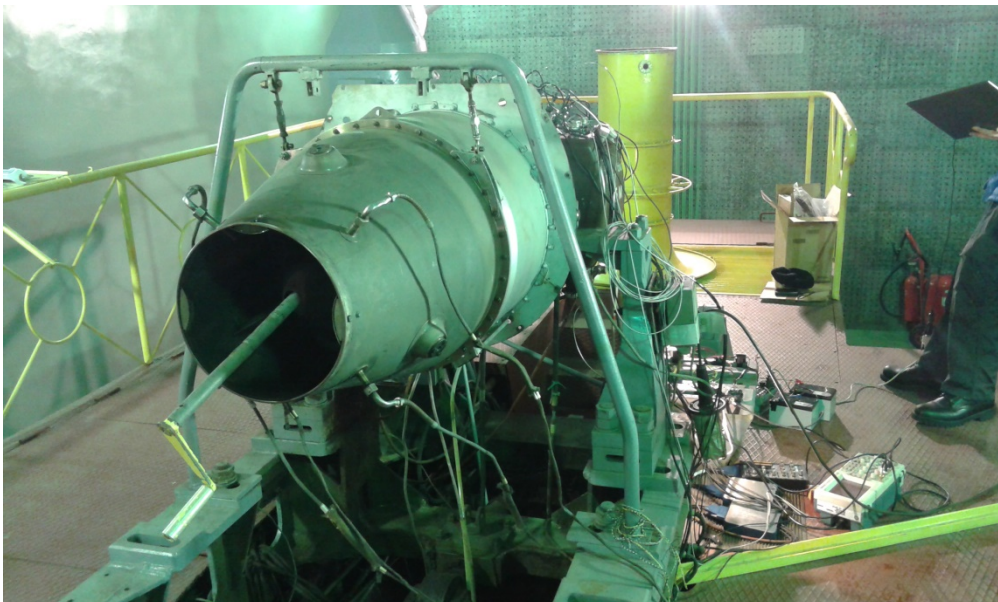
Figura 46. Pruebas de calidad de las señales para los sensores inductivos y para el sensor de fibra óptica previas a los ensayos.
