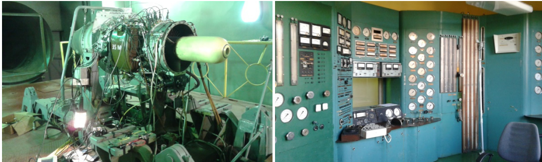
Figura 26. Motor SO-3 en el banco de ensayos (izquierda) y sala de control (derecha). Imágenes cortesía del ITWL.
