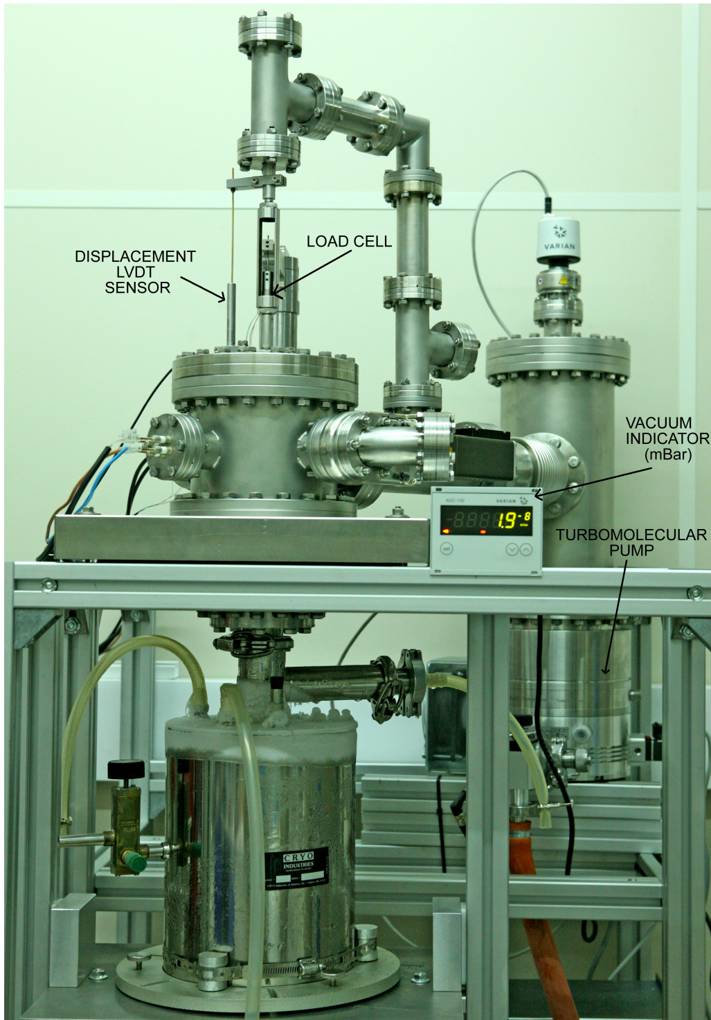
Figura IV.17. Fotografía de la instalación de medida bajo UAV [Lop 14].
