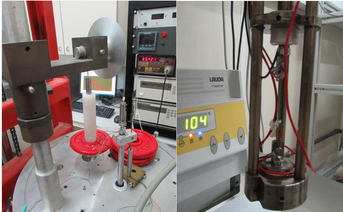
Figura IV.13. Fotografías del equipo de medida de la resistividad y la deformación durante la transformación térmica bajo carga. En la imagen de la izquierda se muestra en un primer plano parte del sistema mecánico mientras al fondo se puede observar parte de la electrónica del sistema. En la imagen de la derechas se muestra el detalle del sistema mecánico de mordazas y muestra.
