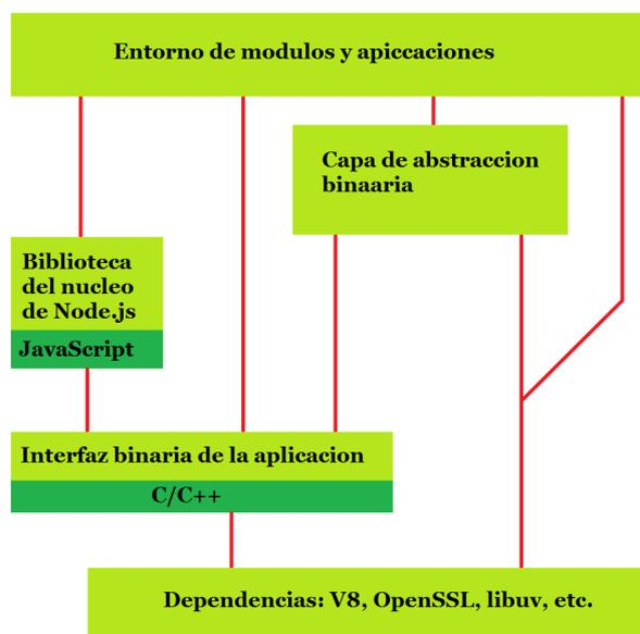
Figura 4.8: Esquema de la arquitectura de Node.JS.
