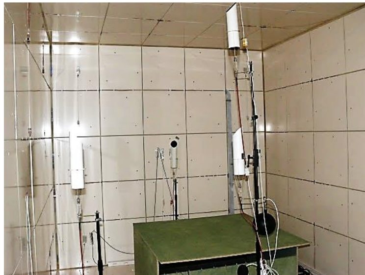
Figura 2.2 – Sala de ensayo con el muro de calibración instalado
