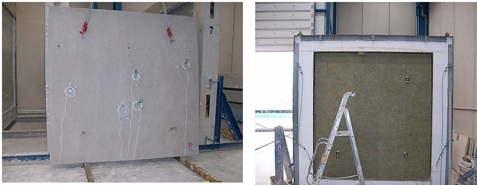
Figura 4.25 – Hoja de hormigón con la instrumentación de medida colocada y muro base con los topes de apoyo para la formación de la cámara ventilada
