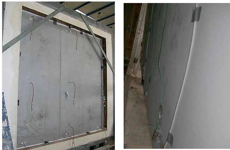
Figura 4.31 - Cara interior de la muestra con las sonda de temperatura de aire, izquierda; termopila instalada en la cámara ventilada, derecha
