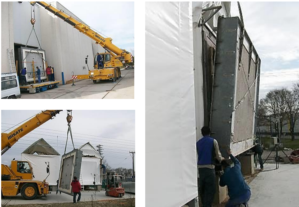
Figura 4.28 - Movimiento de la muestra desde el pabellón de montaje y colocación en la celda EGUZKI
