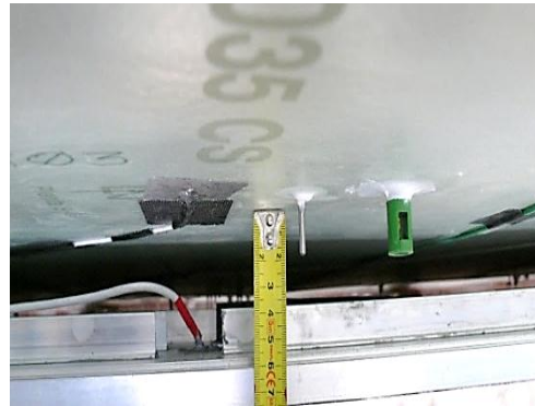
Figura 1.37 – Medida del perfil de temperaturas de aire en la cámara ventilada
