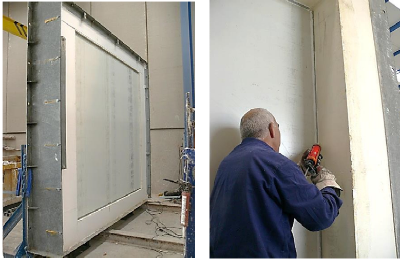
Figura 4.38 – Hoja interior montada y detalle del sellado de juntas
