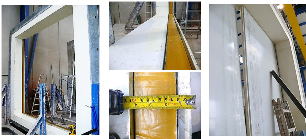
Figura 4.37 – Montaje de la hoja interior en el portamuestras
