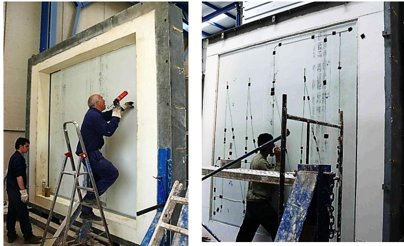
Figura 1.33 – Construcción y colocación de la instrumentación en la muestra
