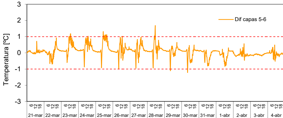
Figura 4.61 – Diferencia de temperatura media entre la capa 6 , superficie externa, y la capa 5 , tras el revestimiento de mortero, en la muestra de muro con aislante
