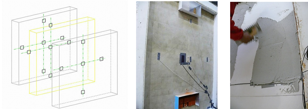
Figura 1.36 – Medida de la temperatura superficial y flujo de calor en las probetas
