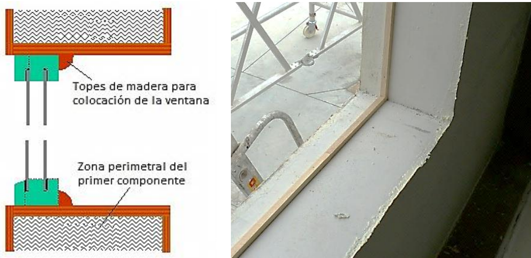
Figura 3.12 – Detalle de la colocación de la ventana a ras de la cara exterior del hueco del muro opaco
