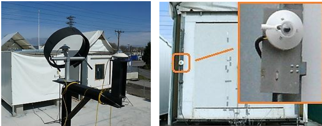
Figura 1.25 – Solarímetros para la medida de las diferentes componentes de radiación
