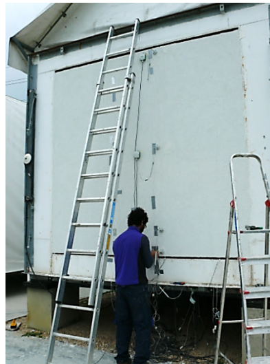
Figura 4.20 – Esquema de montaje de las sondas en la cámara de aire, y detalle de instalación de los termoanemómetros
