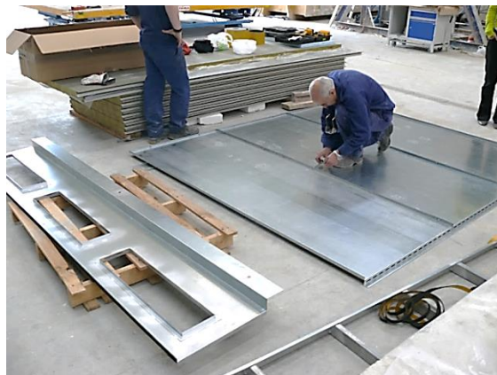
Figura 4.39 – Diseño y montaje de la hoja exterior en la muestra de fachada forzada
