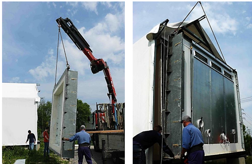
Figura 1.34 – Colocación del portamuestras en la celda de ensayos EGUZKI
