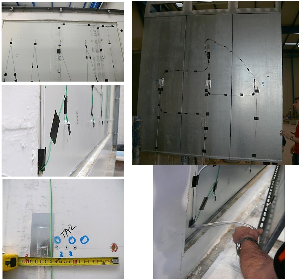
Figura 4.46 – Proceso de instalación de las sondas en la probeta de fachada forzada
