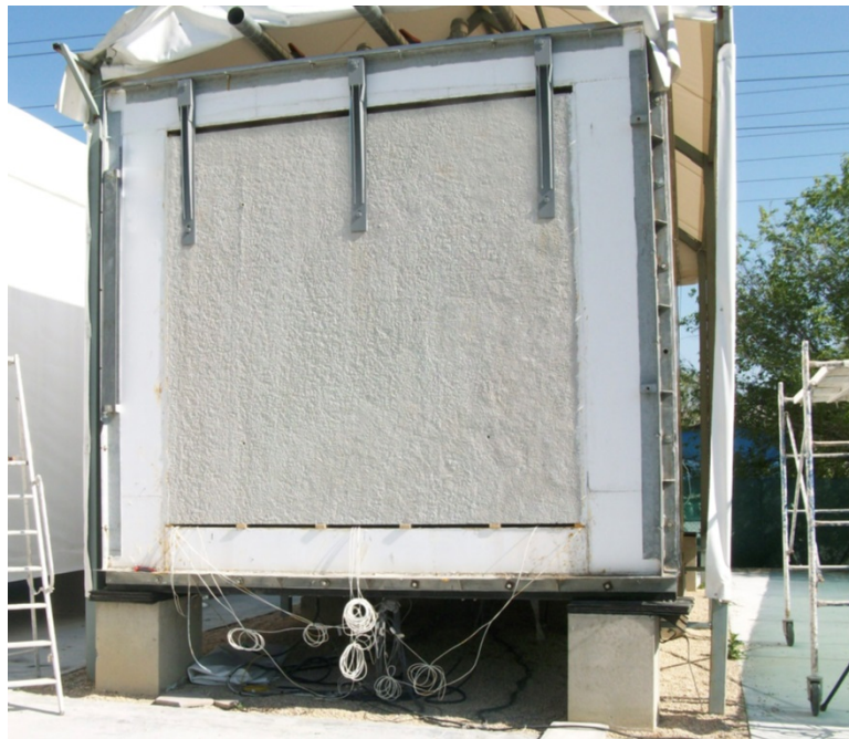
Figura 4.29 - Probeta final instalada con parte de la instrumentación colocada
