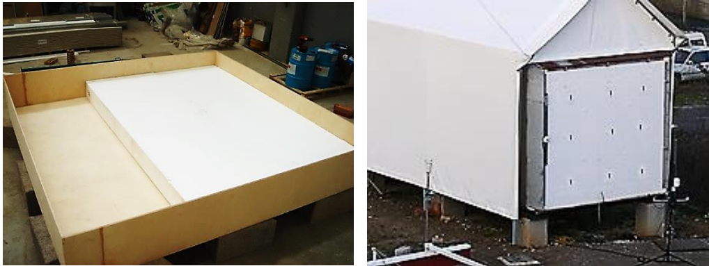
Figura 2.1 – Fabricación e instalación del muro de calibración
