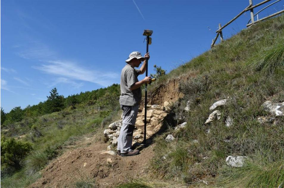
Fig. 6.- Delineación de los elementos exhumados mediante GNSS-RTK.
