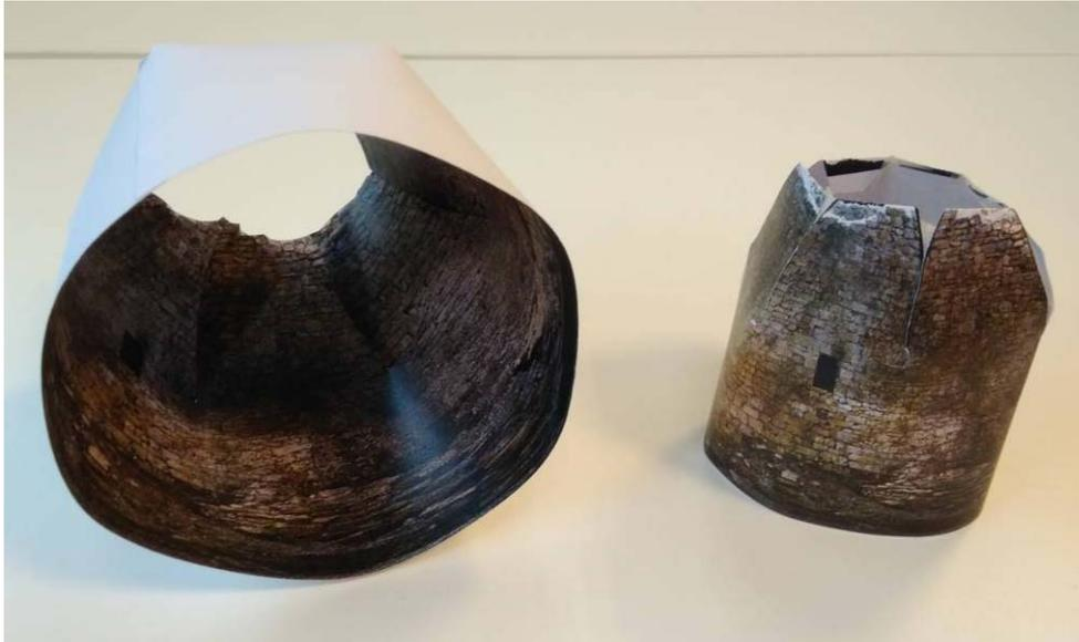
Fig. 42.- Imagen desarrollada del interior de la nevera con la cúpula dividida en seis husos. Impresa, recortada y pegada para formar una maqueta a escala del elemento en 3D.
