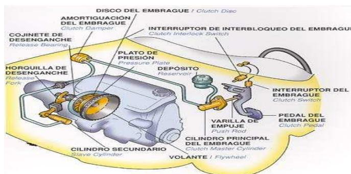
*Imagen 2.9: accionamiento hidráulico*
