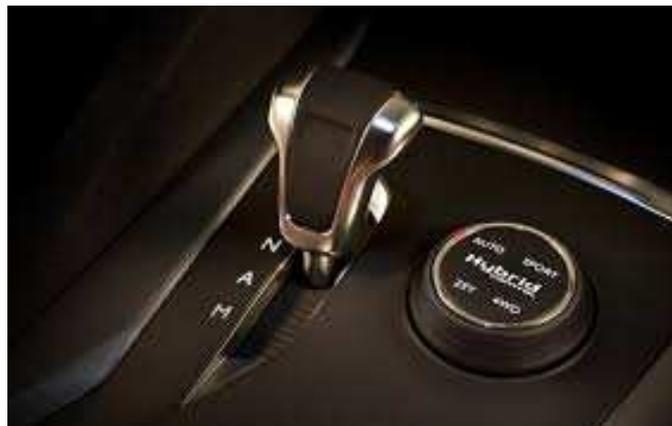
*Imagen 2.15: palanca de cambios para una caja manual pilotada*
