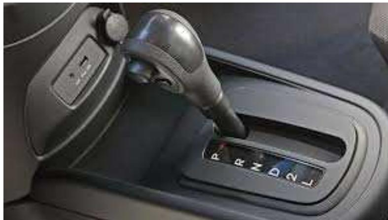
Imagen 2.13: palanca de cambios para una caja automática
