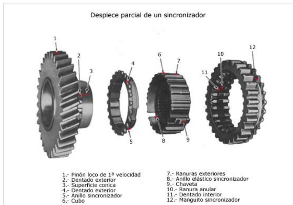
Imagen 3.10: despiece de sincronizador
