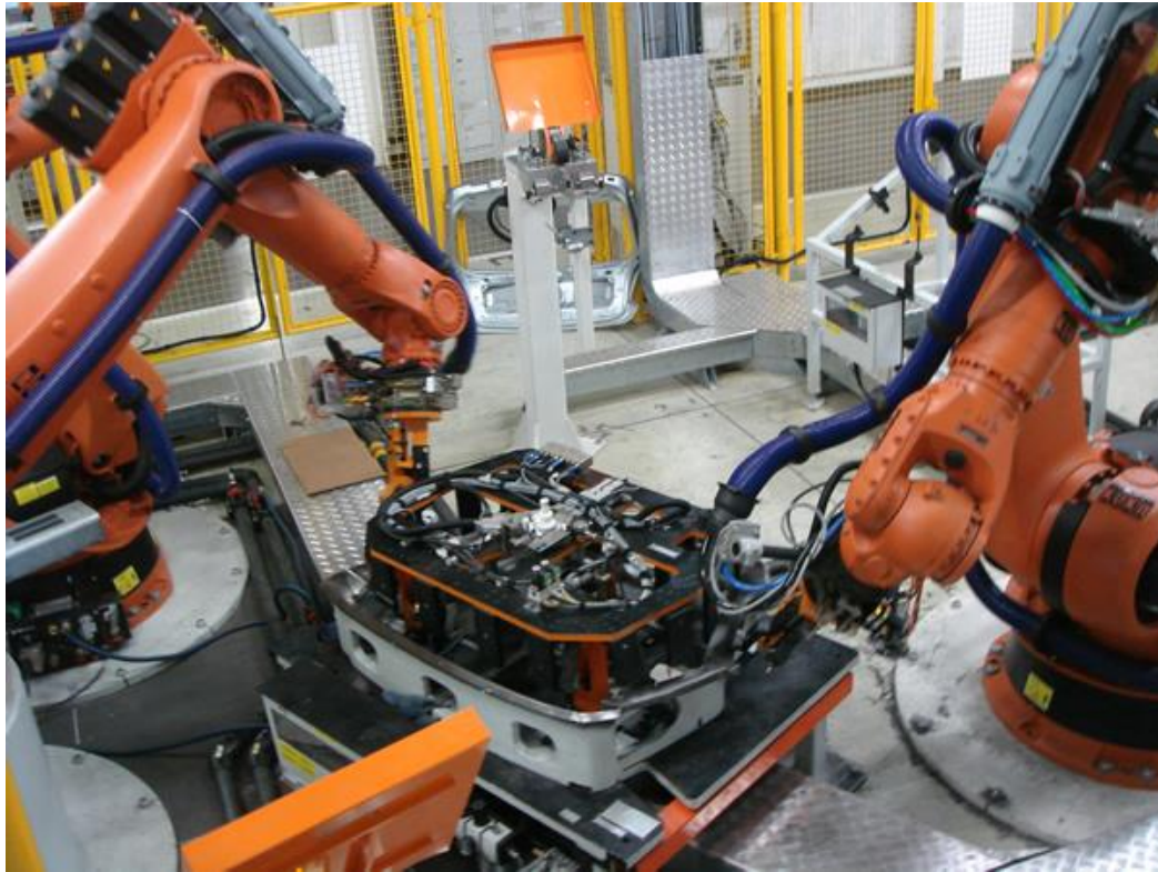
Imagen 7.1 – Estación simple de trabajo para engatillado por roldana (cortesía de INGEMAT SL)
