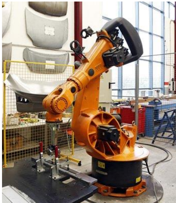
Imagen 3.4 – Ejemplo de engatillador robotizado por roldana (cortesía de INGEMAT SL)
