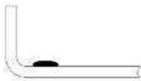
Imagen 3.6 – Aplicación de cordón de cola sobre el panel exterior a engrapar
