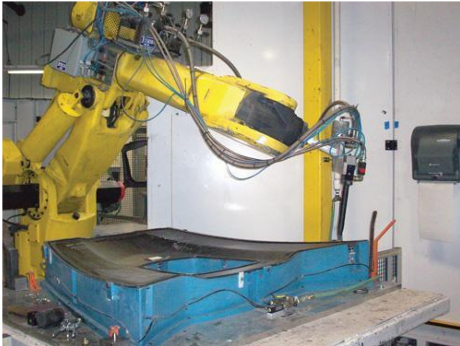
Imagen 3.5 – Ejemplo de aplicación robotizada de masilla
