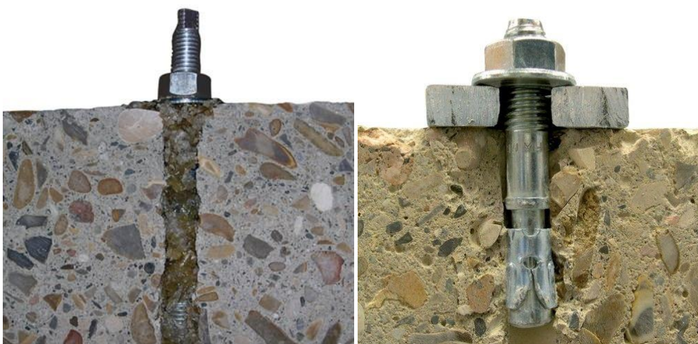
Imagen 8.4 – A la izquierda Spit químico, a la derecha Spit mecánico
