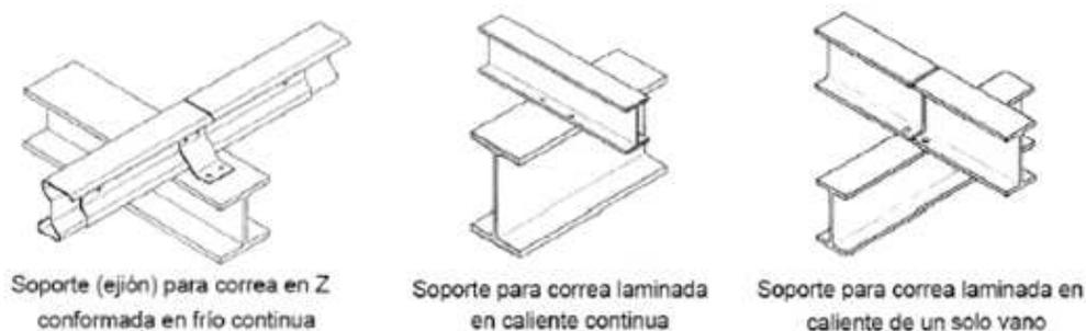
2.23. Distintos Tipos de Sujeciones Correa-Viga en Función de los Perfiles Unidos
