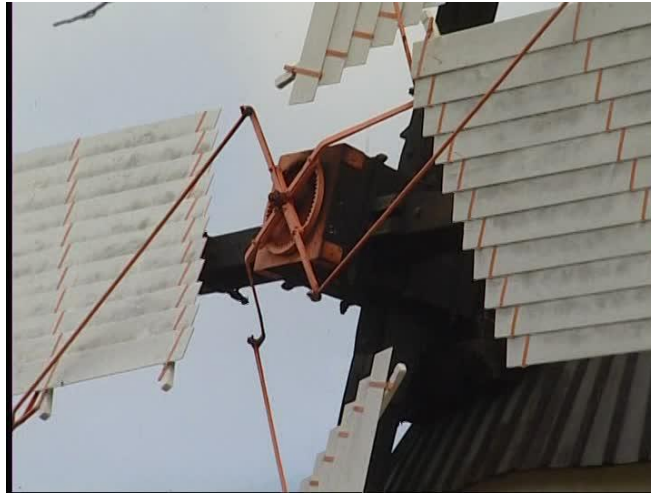
Figura 31. Aspas con regulador centrífugo
