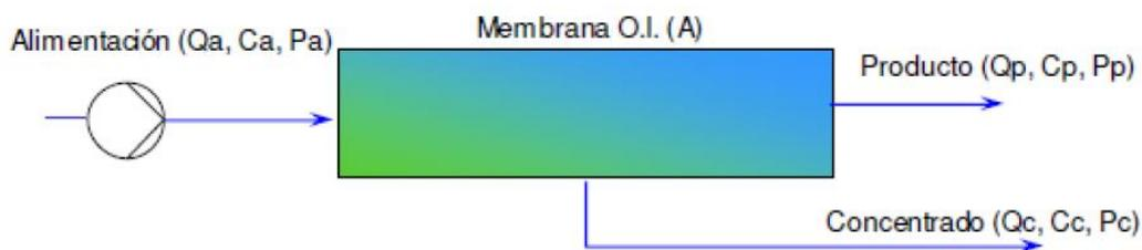
Figura 5.20: Esquema del proceso de ósmosis inversa de un paso
