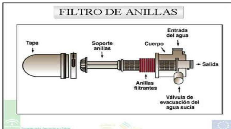
Figura 5.6: Esquema de un filtro de anillas
