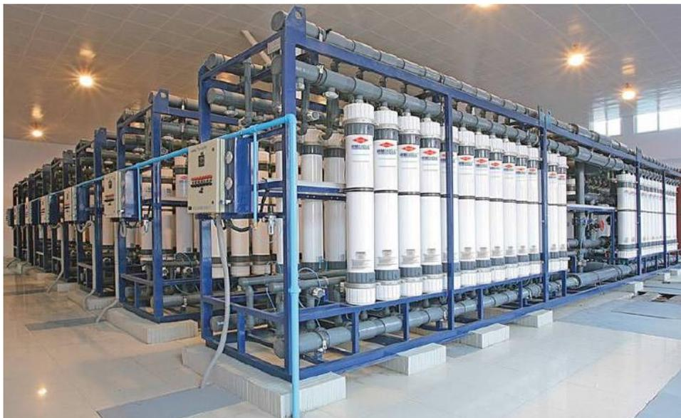
**Figura 5.9:** Detalle de una instalación con módulos de ultrafiltración de la marca DOW<sup>TF</sup> UF [Manual]
