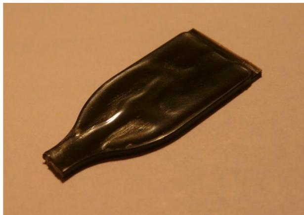
Ilustración 10. Rechupe en probeta.
