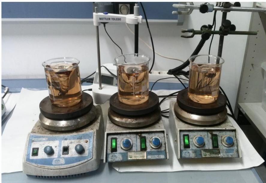
*Ilustración 6. Tres disoluciones de dopamina en proceso de oxidación.*
