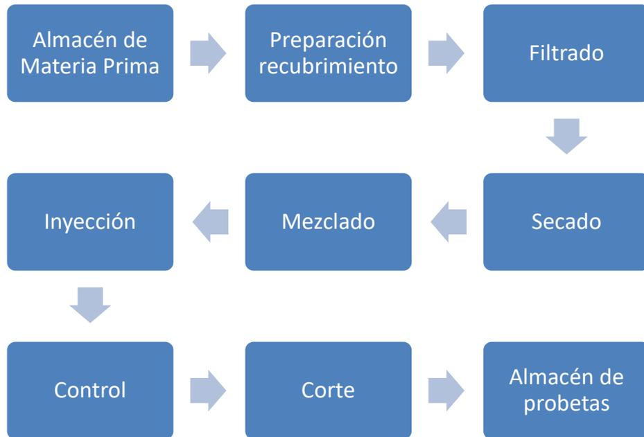
Ilustración 5. Proceso de elaboración PLLA-BaSO<sub>4</sub> recubierto.
