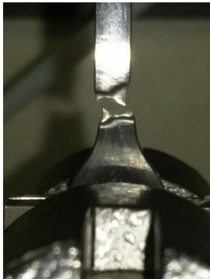
*Ilustración 16. Rotura a tracción por aglomeración.*
